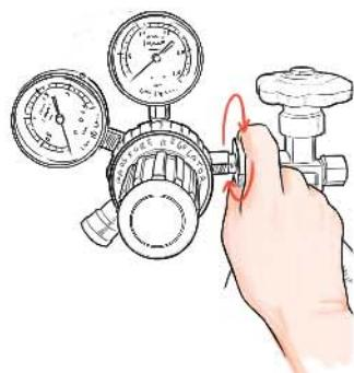
ボンベの継手部分と圧力調整器の袋ナットを接続し、手で締められるところまで、締めていきます。
